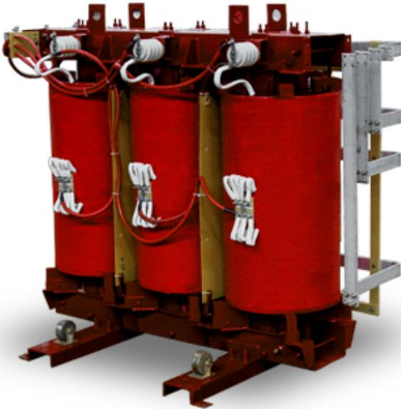
Сухие трехфазные силовые трансформаторы с литой изоляцией HYBRicast типа ТСЛ и ТСЗЛ используются для преобразования электроэнергии в сетях переменного тока с частотой 50 Гц. В трансформаторах данной серии предусмотрена возможность пятиступенчатой регулировки напряжения типа ПБВ с диапазоном  $\pm 2 \times 2,5$  % от номинального напряжения по стороне 10(6) кВ.
