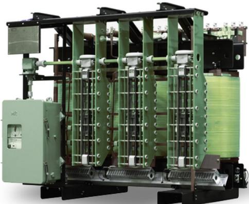
Сухие трехфазные силовые трансформаторы с естественным и искусственным воздушным охлаждением типа ТС и ТСЗ используются для преобразования электроэнергии в сетях переменного тока с частотой 50 Гц. Трансформаторы данной серии имеют переключающее устройство РПН для семиступенчатой регулировки напряжения по стороне ВН.
