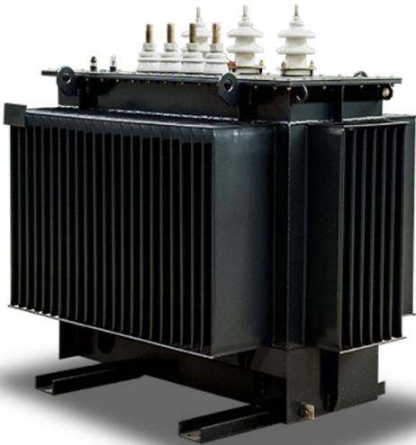
Масляные трехфазные силовые трансформаторы с естественным масляным охлаждением типа ТМ используются для преобразования электроэнергии в сетях переменного тока с частотой 50 Гц. В трансформаторах данной серии предусмотрена возможность пятиступенчатой регулировки напряжения типа ПБВ с диапазоном  $\pm 2 \times 2,5$  % от номинального напряжения по стороне 35 кВ.
