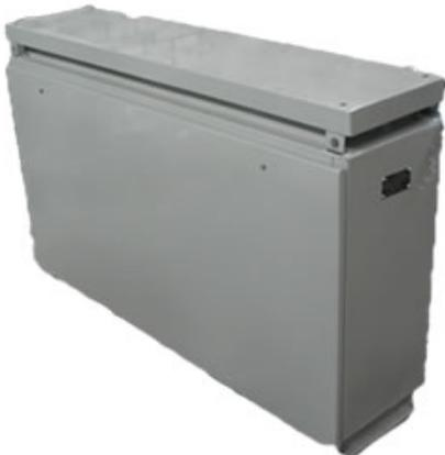
Выпрямители УВК предназначены для питания грузоподъемных электромагнитов типов М-22, ПМ-15, М-42, М42-Б, М-40, М-62А, ПМ-25А. Токовая отсечка по переменному току, защита вентилей от тока короткого замыкания и длительных перегрузок по постоянному току - гарантия надежности специальных выпрямителей УВК. Трехфазные выпрямители УВК не обеспечивают удержания груза при пропадании питания и исключают возможность подключения конденсаторных батарей к устройству. Номинальная частота 50 Гц.
