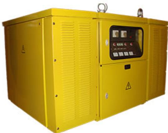
ВА – 2х750-28,5/57 - аэродромный выпрямитель тока, предназначенный для питания бортовых потребителей электроэнергии на самолетах и вертолетах в процессе их технического обслуживания в аэропортах гражданской авиации, а также для запуска двигателей по системе 24/48 В. Питание выпрямителя аэродромного осуществляется от сети переменного тока с нулевым проводом напряжением 380 В и частотой 50 Гц.
