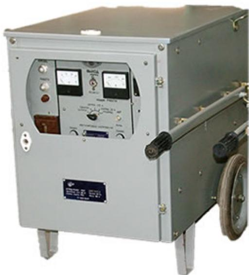
Выпрямители В-ТППД с номинальным током 315 А применяются для зарядки, подзарядки и запуска аккумуляторных батарей, сварочных работ, сушки обмоток электрических машин. Также выпрямители В-ТППД-375-28,5 могут использоваться для питания переносного освещения и ручного электрифицированного инструмента.
