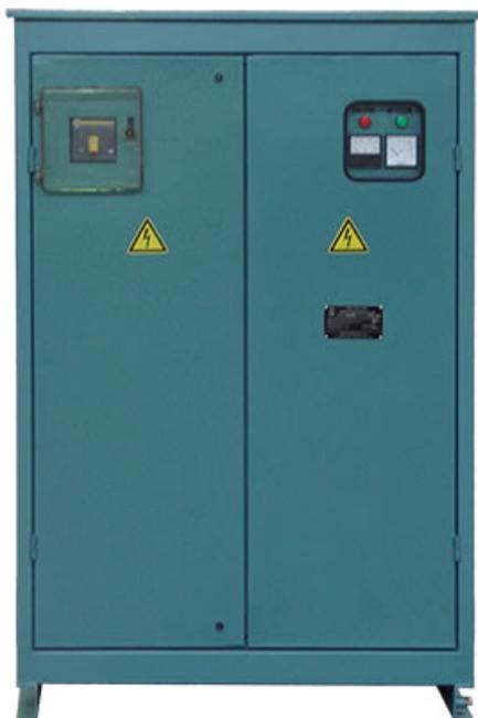
Это надежный источник питания для морских и речных судов. Специальное выпрямительное устройство "Дельфин" предназначено для питания судовой инфраструктуры с берега выпрямленным током напряжение 220 В. Допускается параллельная работа выпрямителей переменного тока на общую нагрузку, однако при этом, следует учитывать, что нагрузку на каждое устройство необходимо снизить на 10%.
